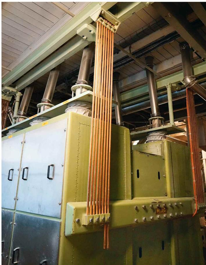
Die Plansichter bringen Schwung ins Mehl: Bis zu 28 verschiedene Siebe trennen das gemahlene Produkt in unterschiedliche Fraktionen. Diese Plansichter wurden früher an Bambusstangen aufgehängt, heute an Kunststoffstangen. Fotos: Antje Scheinert
